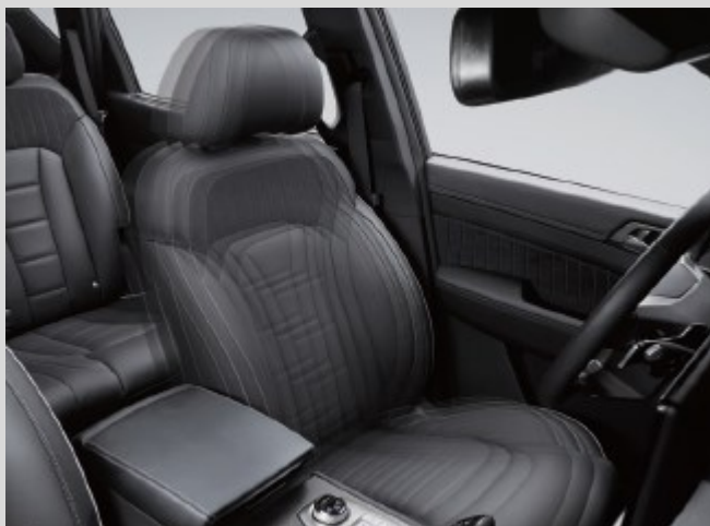
Fahrsitz mit elektrischer 8-Wege-Positionierung und 4-Wege-Lendenwirbelstütze
