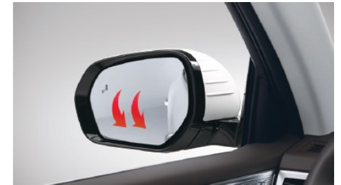
Aut. Abklappbare Spiegel bei Rückwärtsfahrt Rétrov. ext. à inclinaison auto. en marche arrière Specchietti est. i inclinabili auto. in retromarcia
